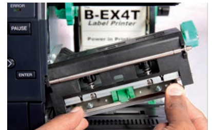
La testina sostituibile senza attrezzi permette una notevole riduzione del tempo di intervento
